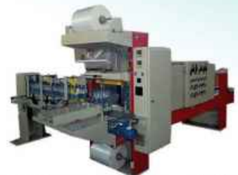
دستگاه شیرینک پک با بدنه رنگ کوره ای ضد خش داری ردیف کن و بلوکه ساز اتوماتیک فرمان PLC ظرفیت ۱۲ بسته در دقیقه
