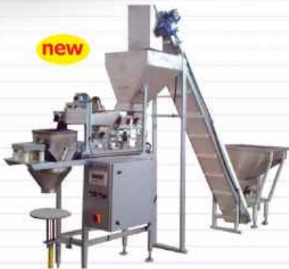
دستگاه فله پرکن گرانول ۲۰ گرم الی ۱۰ کیلوگرم جهت وزن و پرکردن: حبوبات، قند، شکر، تافی، آبنبات و ... اولین و تنها سازنده پرکن گرانول تمام اتوماتیک در ایران
